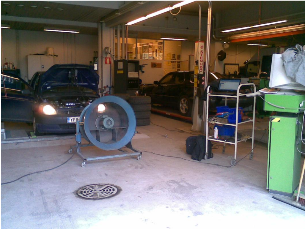
Kuva 4. Toyota Yaris alustadynamometrissa
