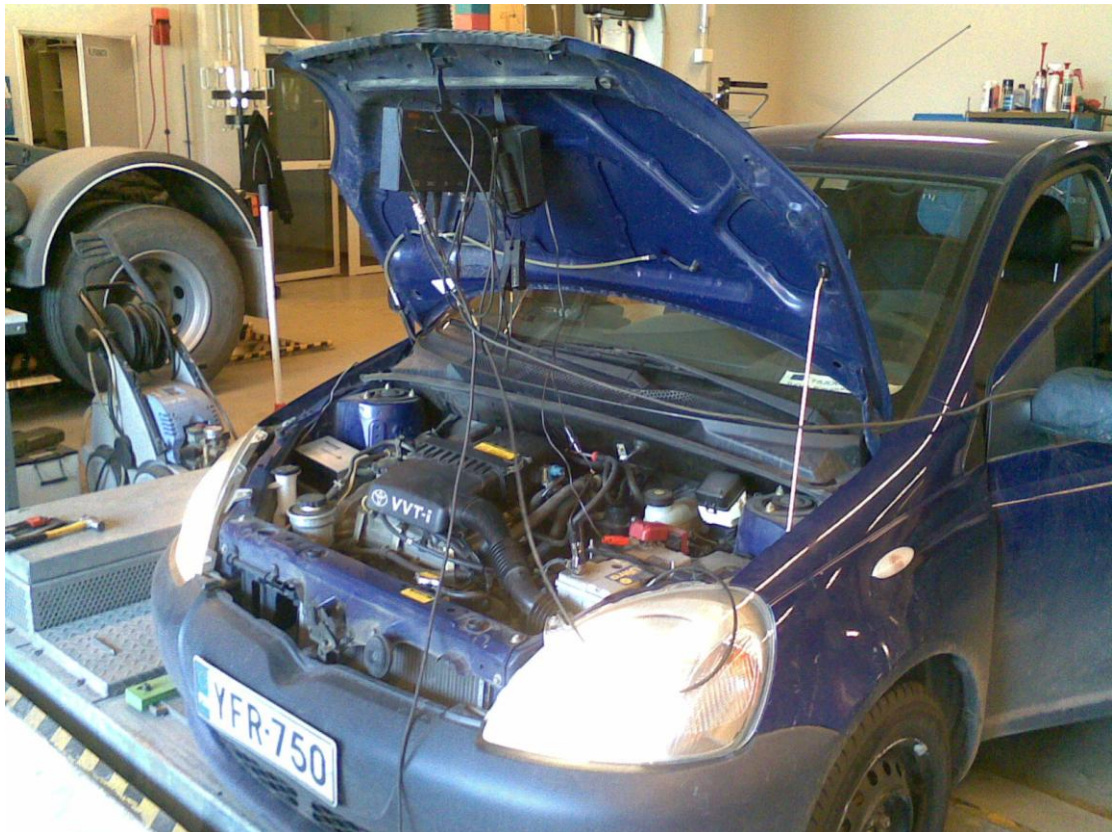
Kuva 1. Toyota Yaris alustadynamometrissa
