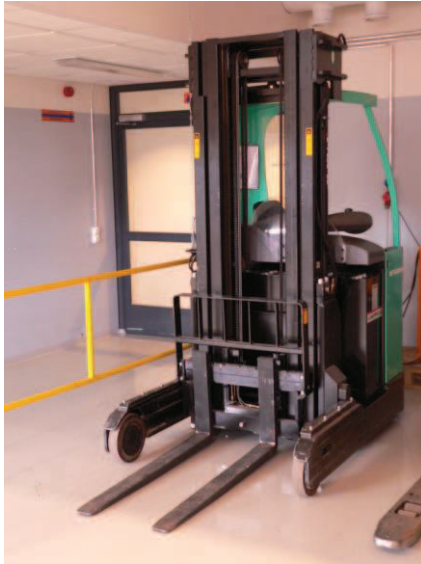
Kuva 4. Työntömastotrukki, Mitsubishi RB 16 KN
