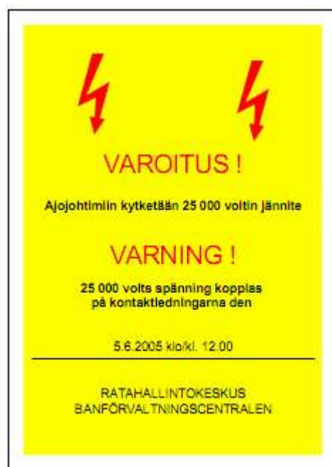
Sähköradan rakennustyömaan varoitusmerkki
