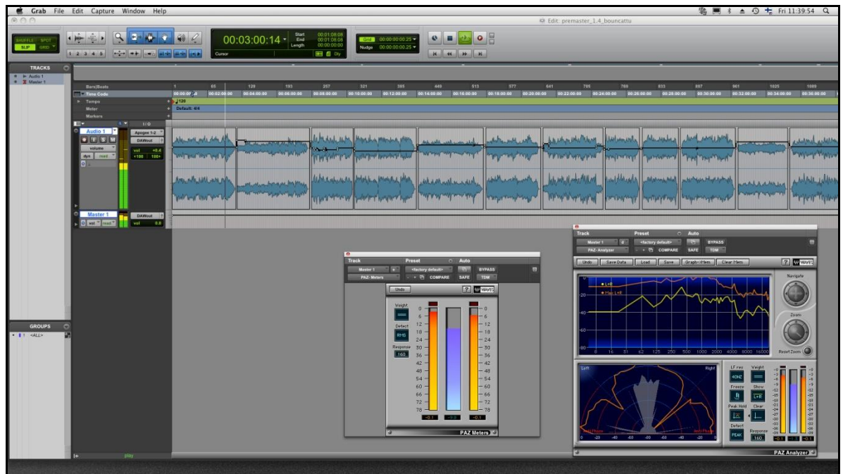
Kuva 5. Masterointi Pro Tools ohjelmassa. Huomaa äänenvoimakkuutta säätelevä musta viiva sinisen ääniaallon päällä.
