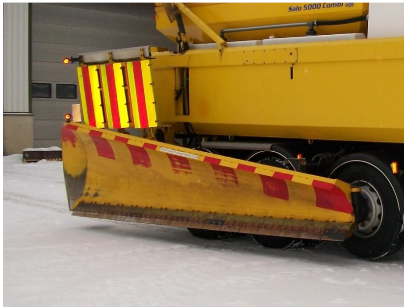
Kuva 7. Leveä sivuaura. Kuva. Eerik Jauhiainen.
