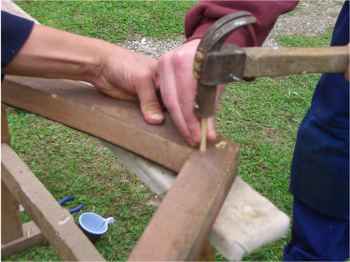
Bild 2 Bågar som lossnat fästs med nya trätappar
