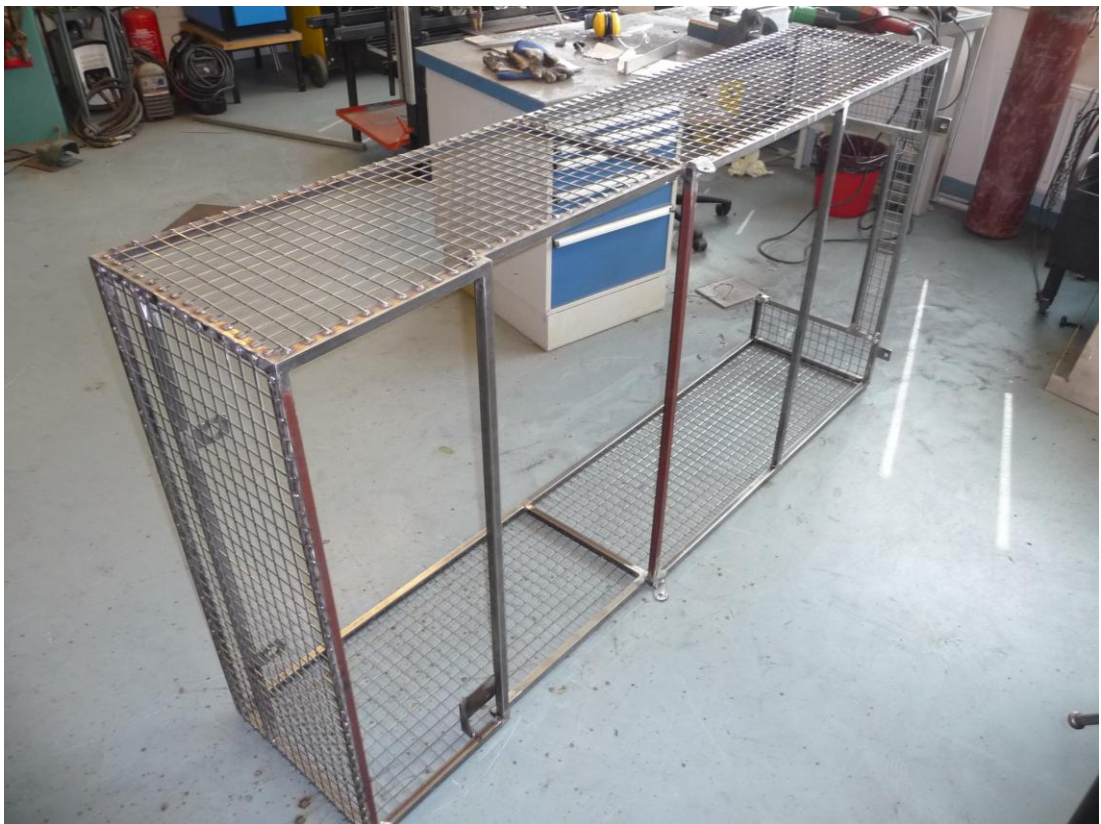
Kuva 4, Valmis suojakehikko maalaamattomana
