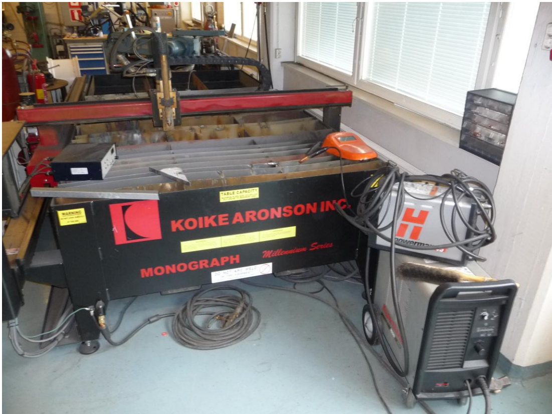
Kuva 3, Koike Aronsonin valmistama plasmaleikkuri ja sen virtalähde
