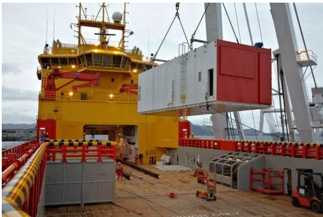
Kuva 27: Polttokennoyksikön nosto Viking Lady alukseen (Tognum 2009).
