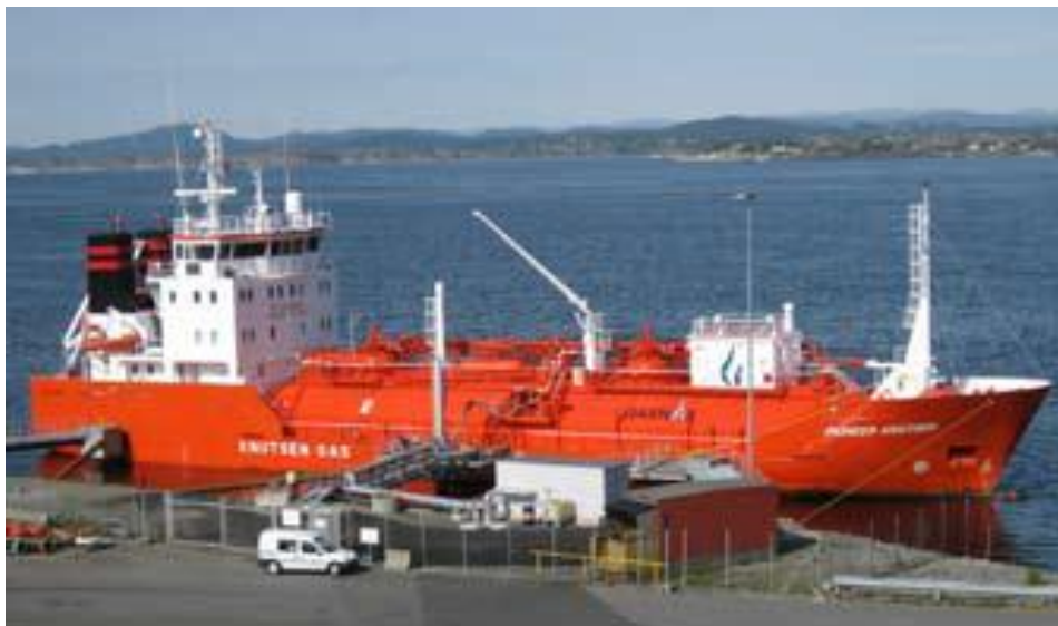
Kuva 21: LNG-käyttöinen laiva ottamassa polttoainetta (SMTF 2010).
