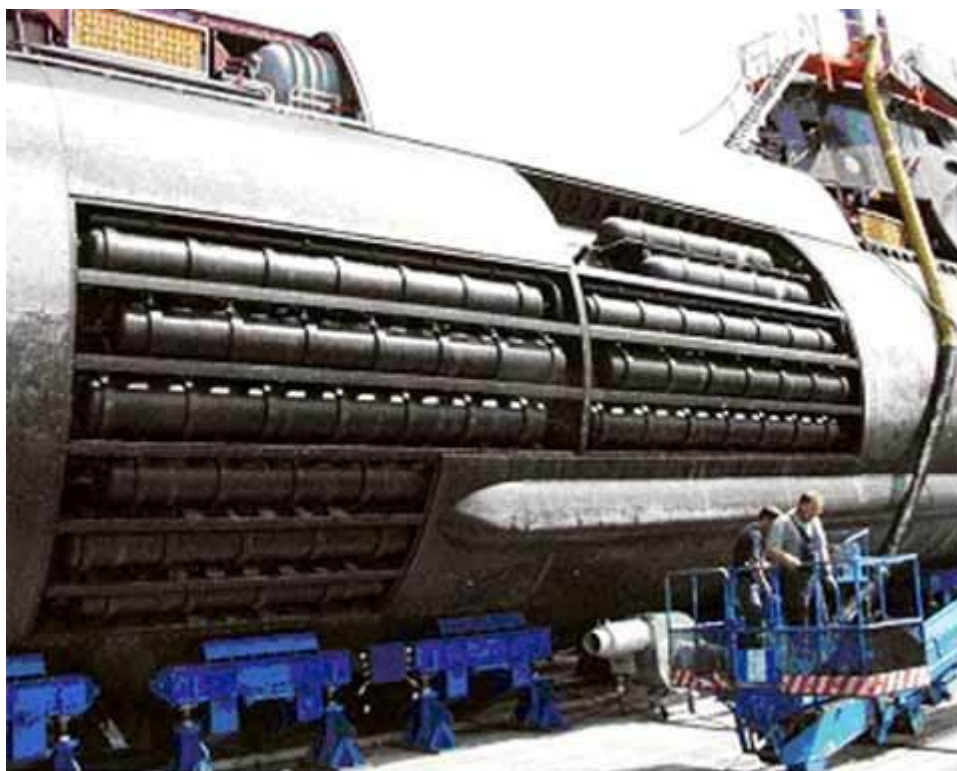
Kuva 24:U212 sukellusveneen metallihydraattisäiliöt (hydrogencommerce.com 2003).
