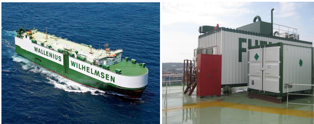
Kuva 28: Wallenius Marinen Udine alus (vas.) ja Wärtsilän 20 kW:n prototyyppiyksikkö aluksen kannella (METHAPU D14.1 2010, 2).
