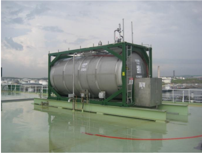
Kuva 22: Metanolisäiliö Wallenius Marinen Udinen kannella (METHAPU D14.1 2010, 2)
