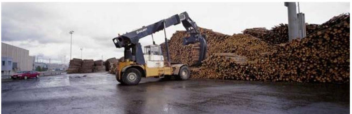
KUVIO 2. Puutavaran pinoamista kurottajalla (KnowPulp 2001–2002.)
