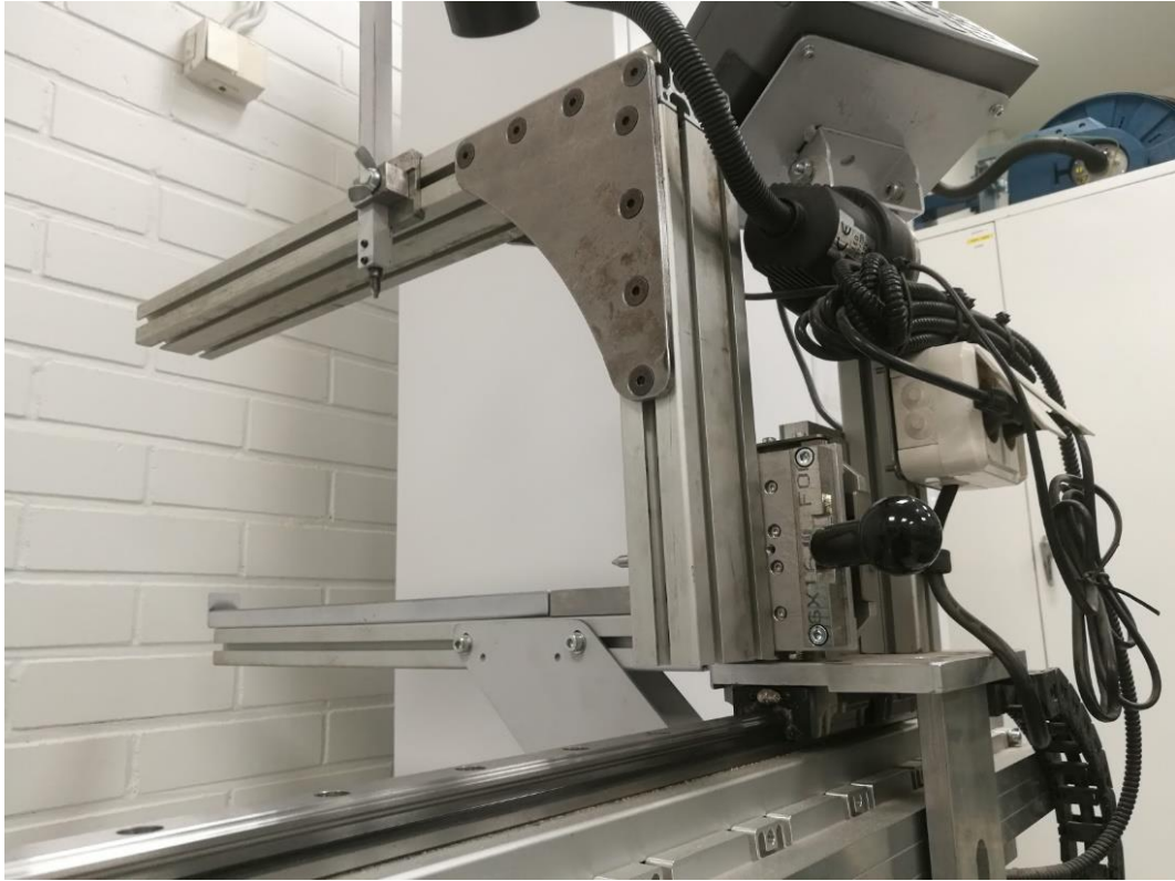
Kuva 5. Mittalaitteen kartion malliset kärjet reikävälien mittaamiseen
