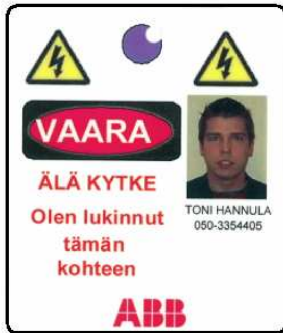
KUVA 25. ABB:n käyttämä henkilökohtainen lukituskortti, joka sijoitetaan erotettuun ja lukittuun kohteeseen
