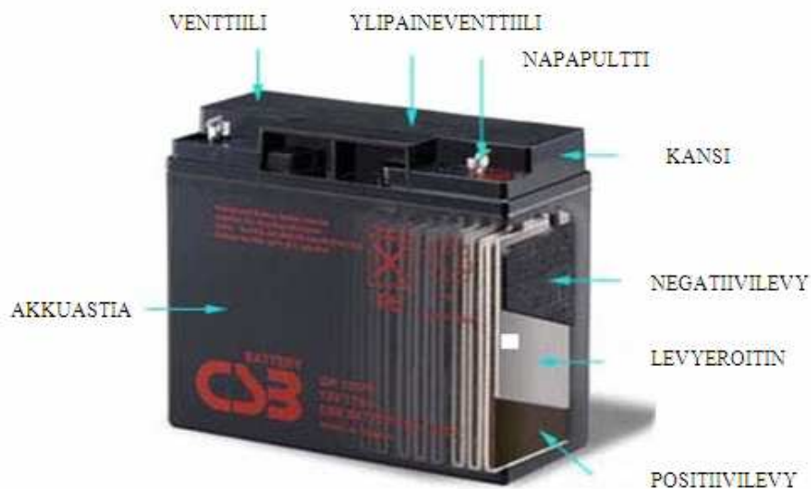
KUVA 22. Suljetun lyijyakun komponentit sekä akun rakenne poikkileikkauksena [19]
