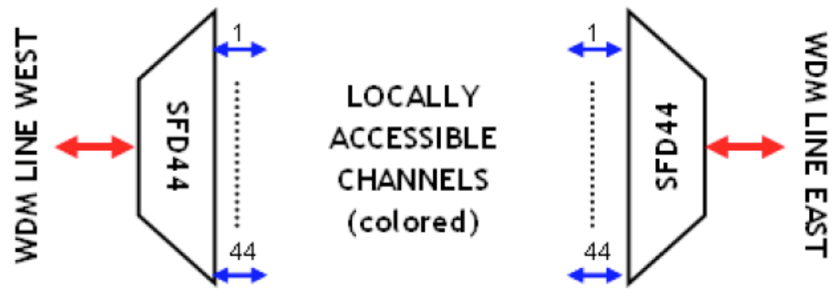
Kuva 14. FOADM, 44-kanavaisen staattisen suodattimen arkkitehtuuri (2-asteinen) [18]
