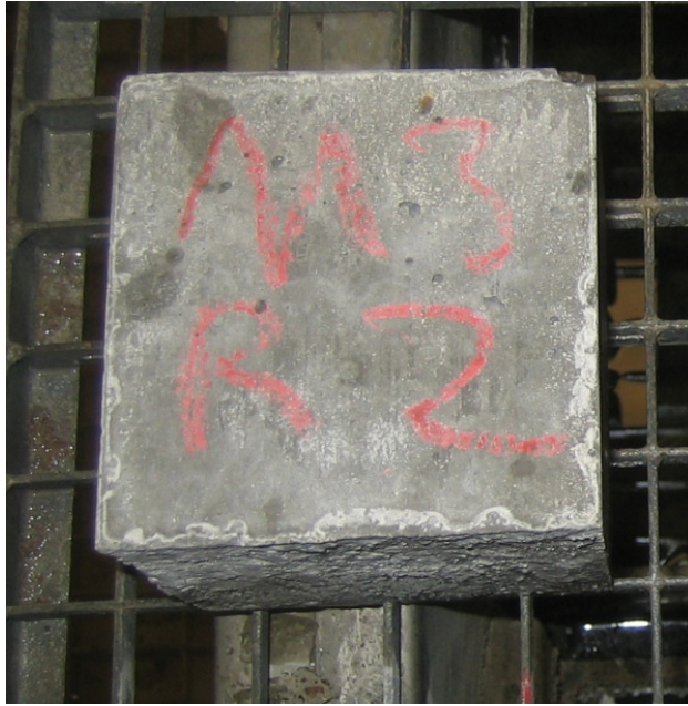
Kuva 6. koekappale ennen rikkihappoliuokseen laittamista (KYAMK rakennuslaboratorio)
