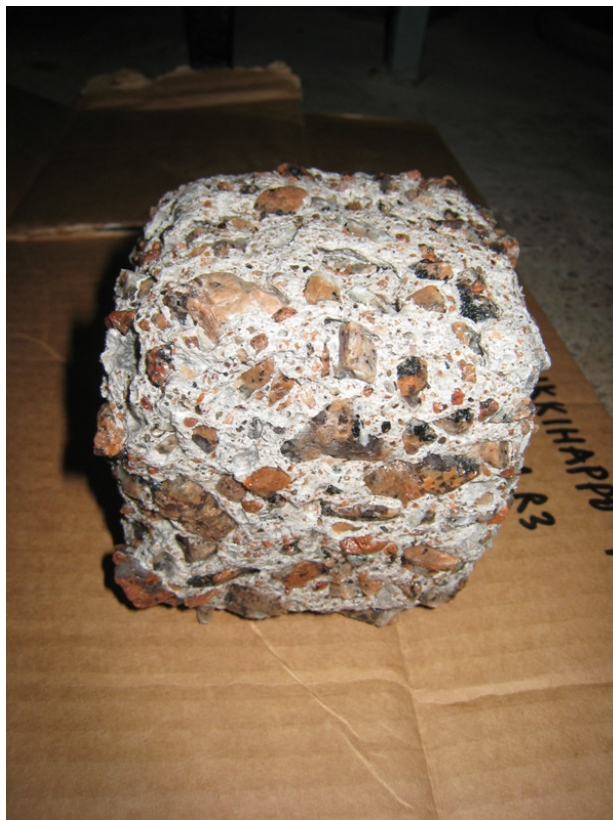
Kuva 7. Koekappale 12kk jälkeen (KYAMK rakennuslaboratorio)
