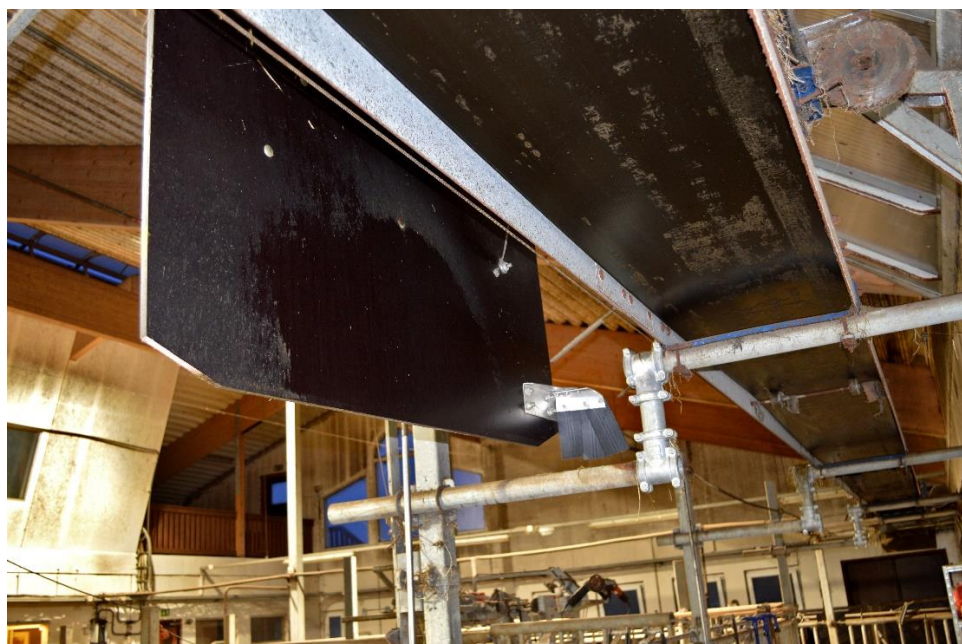
KUVA 12. Uusi ohjainlevy ja kiinnityspotki (Rissanen 2019-11-28.)
