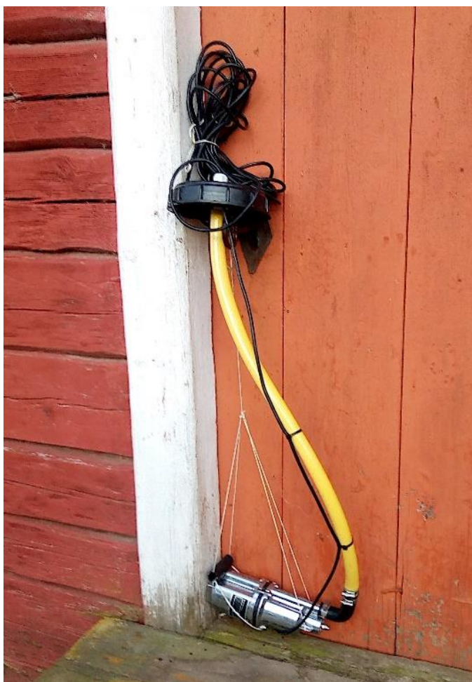
KUVA 17. Konttiin asennettava pumppuryhmä (Rissanen 2019-06-06.)
