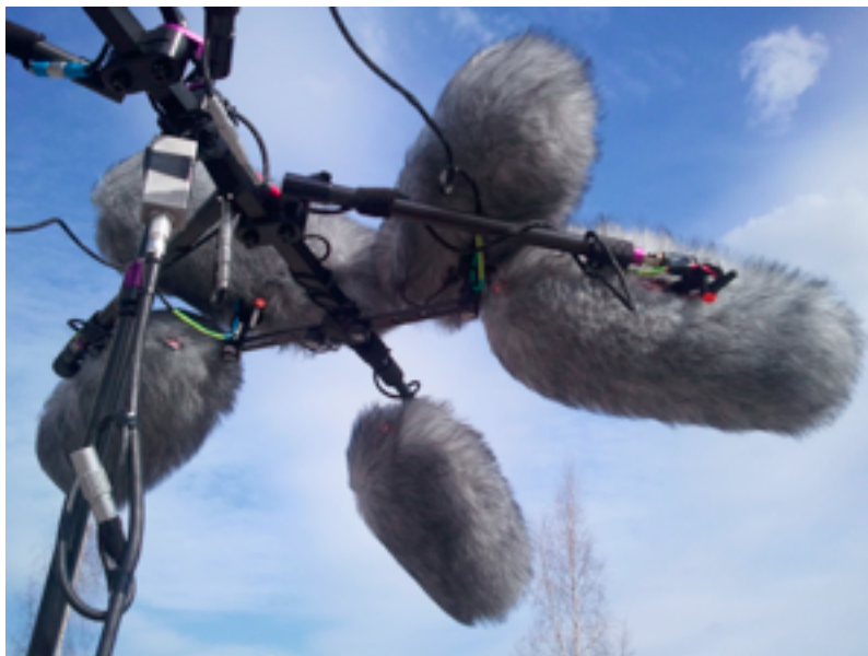
Kuva 8: A-ray:n keskipuomiin teipatut stereosillat mahdollistavat takamikrofonien sijoittamisen lähemmäksi etupäätä.
