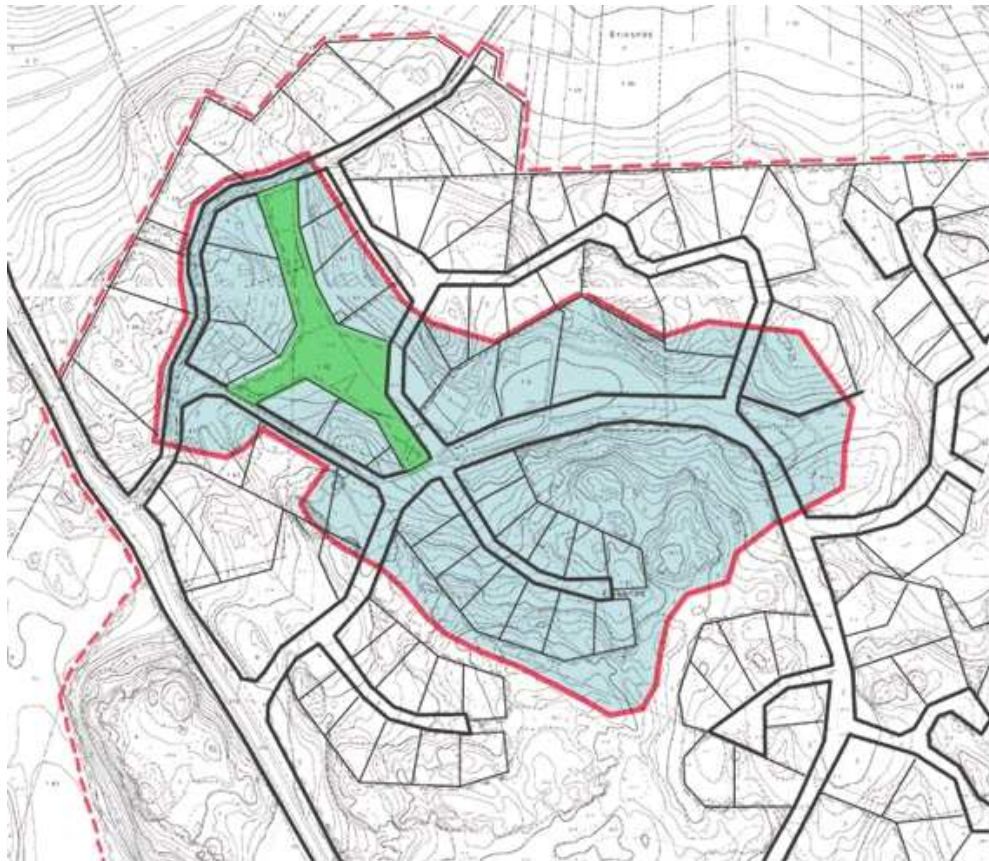
KUVIO 8. Valuma-alueen rajaus. Kartassa on merkitty punaisella rajauksella ja sinisellä pohjalla valuma-alue. Vihreäalue merkkää suunnittelualuetta ja punainen katkoviiva asemakaavan rajaa.
