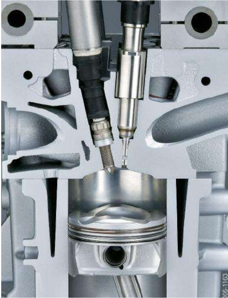
Kuvio 14. N54-moottorin kannen poikkileikkaus. (BMW N54 Engine Mechanical, 6.)
