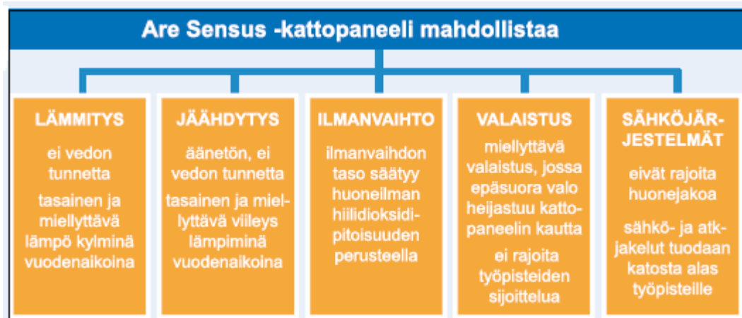
Kuva 2. Are Sensus -kattopaneelin edut
