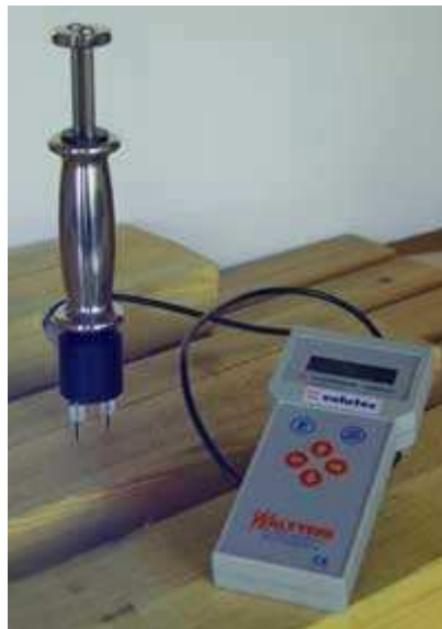
KUVIO 25. Sähkönjohtavuusmittari vasarayksiköllä (Stenlund 2010)
