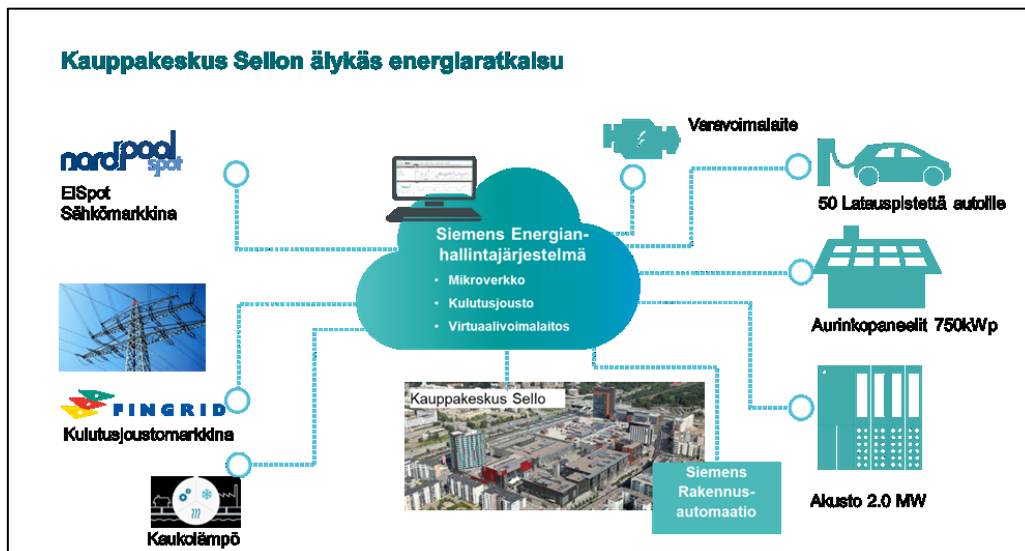
Kuva 12 Kauppakeskus Sellon älykäs energianjärjestelmä perustuu Siemensin EnergyIP sovellusratkaisuun.
