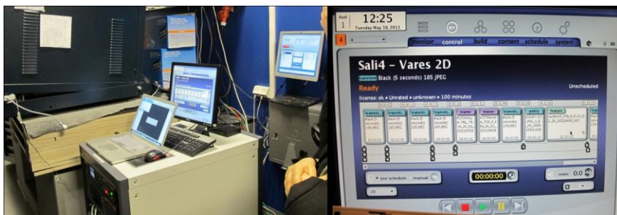
Kuva 22. Kuvassa oikealla on Dolbyn Media Block ja hallintajärjestelmä. Vasemmalla on lähikuva elokuvanäytöksen hallintasovelluksesta (71).
