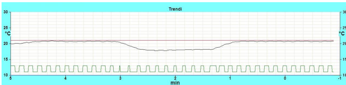
KUVA 25. Pulssinleveyssäätö. Myös tässä kuvassa on simuloitu kotona/poissa-kytkimen käyttöä aikavälillä 1 - 3 min.
