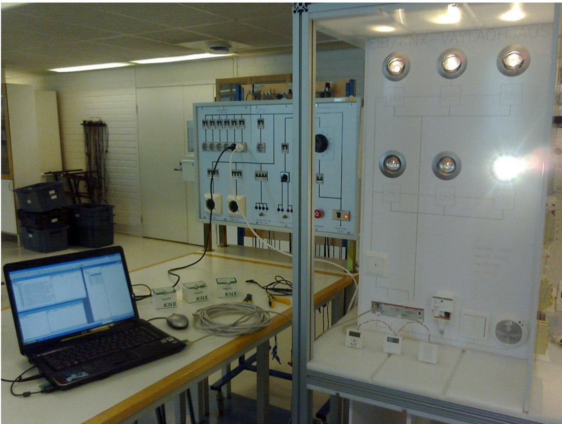
KUVA 26. EIB/KNX- ja DALI -väyläjärjestelmien demolaitteisto.
