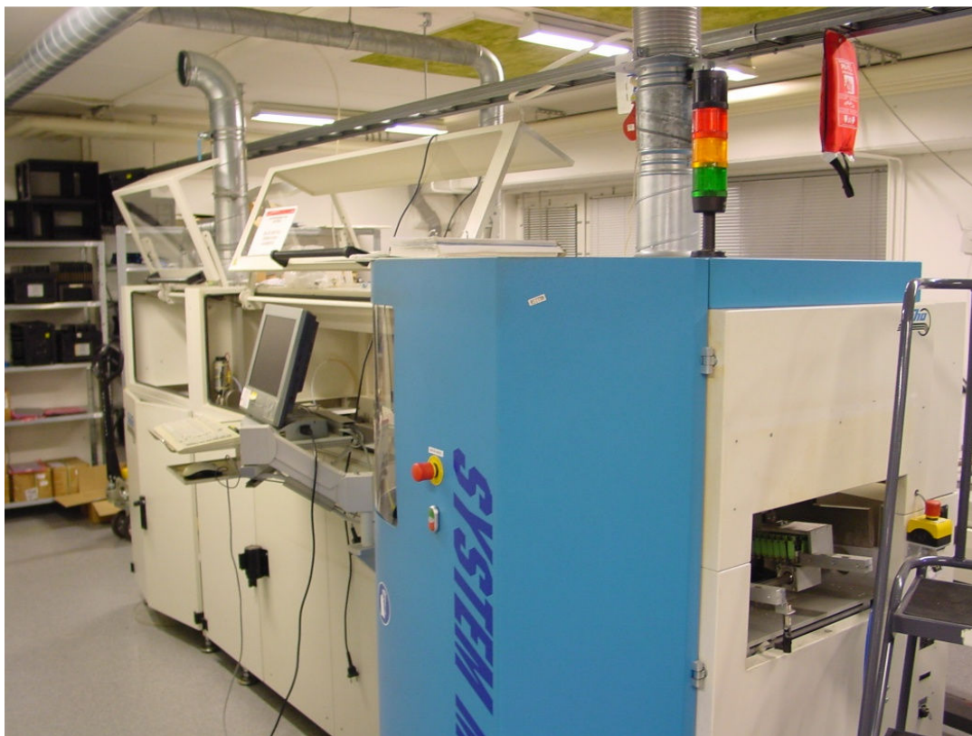
Kuva 7. Seho MWS 8240 -aallojuotoskone
