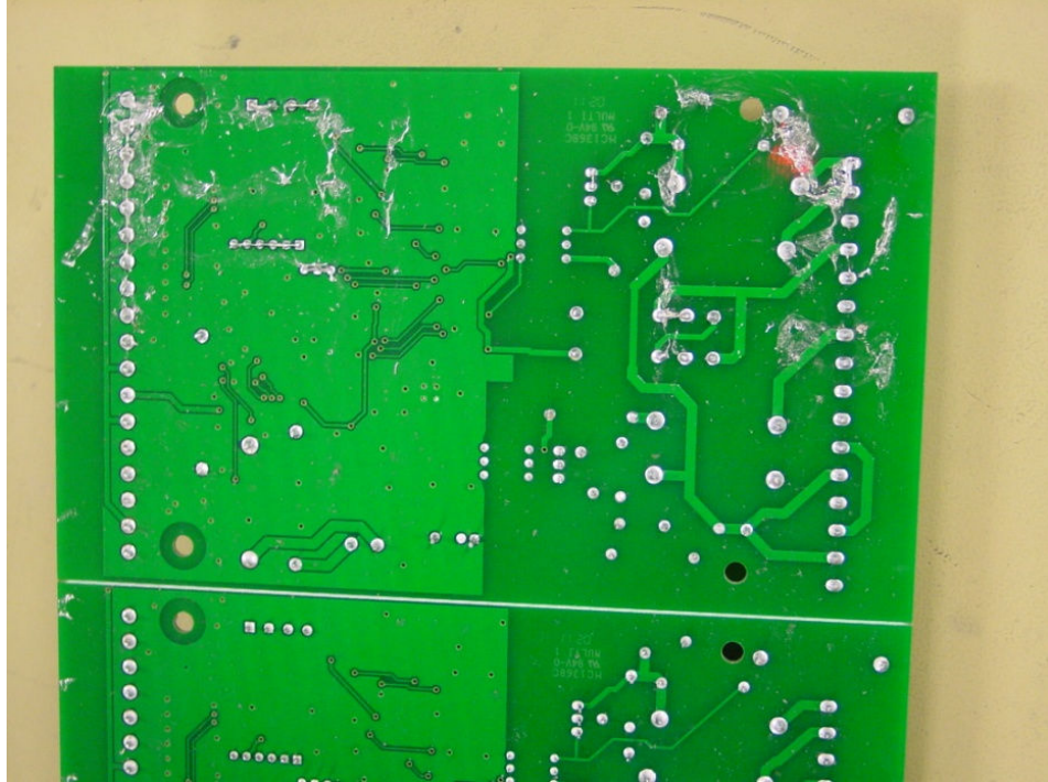
Kuva 11. Osa kortista on jäänyt ilman fluksia
