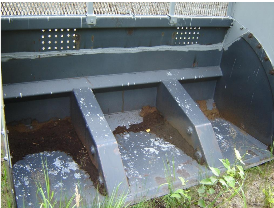
Kuva 4. Pomen malli, jossa kippausrungon kotelot kauhan sisällä.
