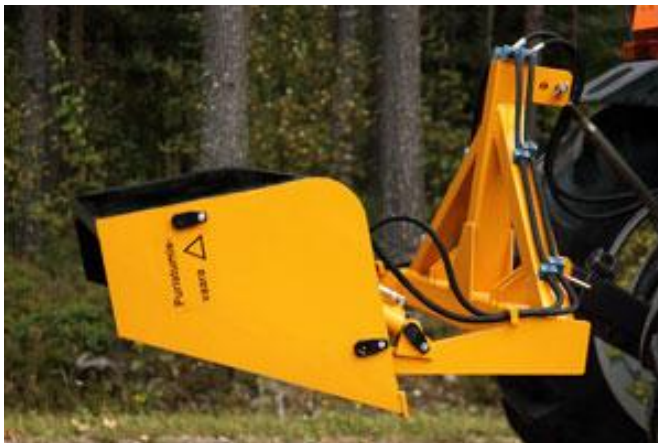
Kuva 2. Raiseliftin 0,6 m 3 kauha kippausasennossa. (Raiselift)
