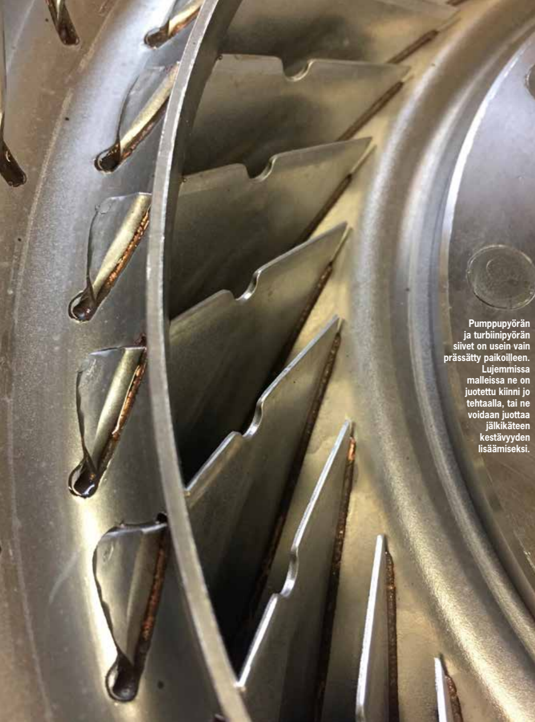
Aivan lopuksi turbiini on tasapainotettava. Tasapainotus on periaatteessa aivan samanlainen tapahtuma kuin renkaan tai kampiakselin tasapainotuskin. Turbiinia pyöritetään ja kone mittaa sen aikaansaamat voimat. Sitten kun turbiini on tasapainossa, ei ylimääräisiä voimia ilmene.
