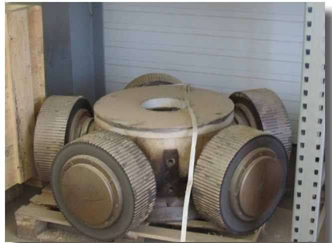
Kuvat yllä: Kahl –pellettipuristimia (tasomatriisi) ja niiden kolleripyörät
