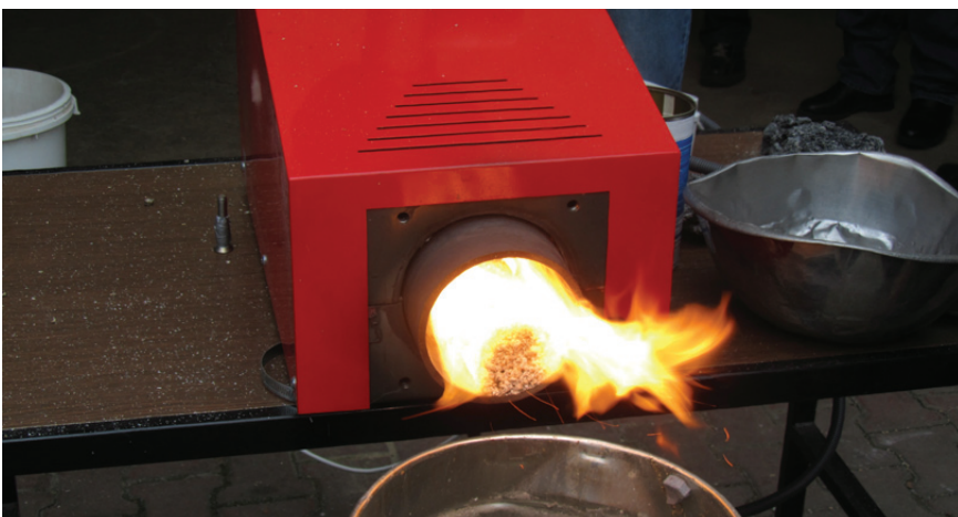
Agropellettien koepolttoa Petrojet – pellettipolttimella.
