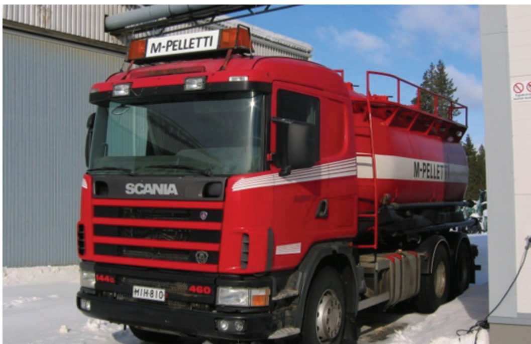
Pelletit toimitetaan usein irtotavarana kuorma-autolla, josta pelletit puhalletaan siiloon paineilmalla.
