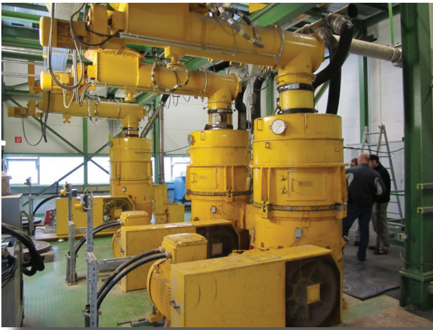
Kuvat yllä: Kahl –pellettipuristimia (tasomatriisi) ja niiden kolleripyörät
