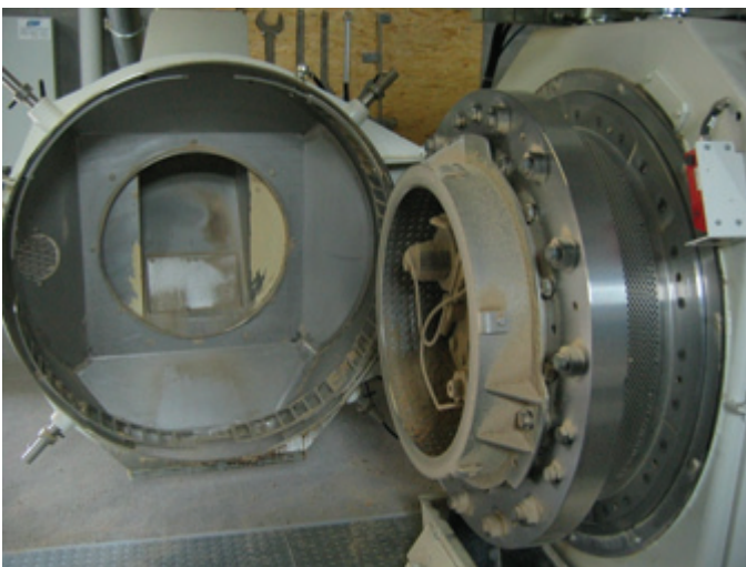
Kuvat yllä: Kaksi erikokoista Bühler –pellettipuristinta (rengasmatriisi). Huomaa erilaiset kolleripyörät kuin Kahl –tasomatriisipuristimella.
