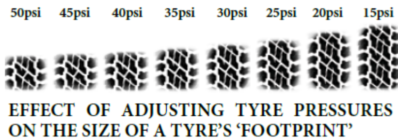
Kuva 4. Rengaspaineen merkitys renkaan ”jalanjälkeen” (Cooper-tyres 2014)
