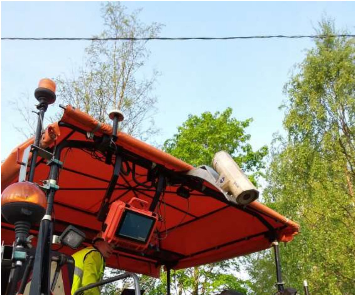
KUVA 2. Levittimeen asennettuna lämpökamera, tiedonkeruuyksikkö sekä GPS-paikannin ja mobiiliverkkoantenni.
