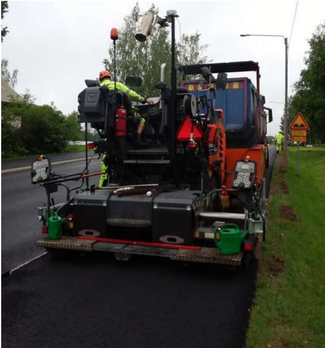
KUVA 5. Lämpökamerajärjestelmä käytössä pienemmässä levittimessä.
