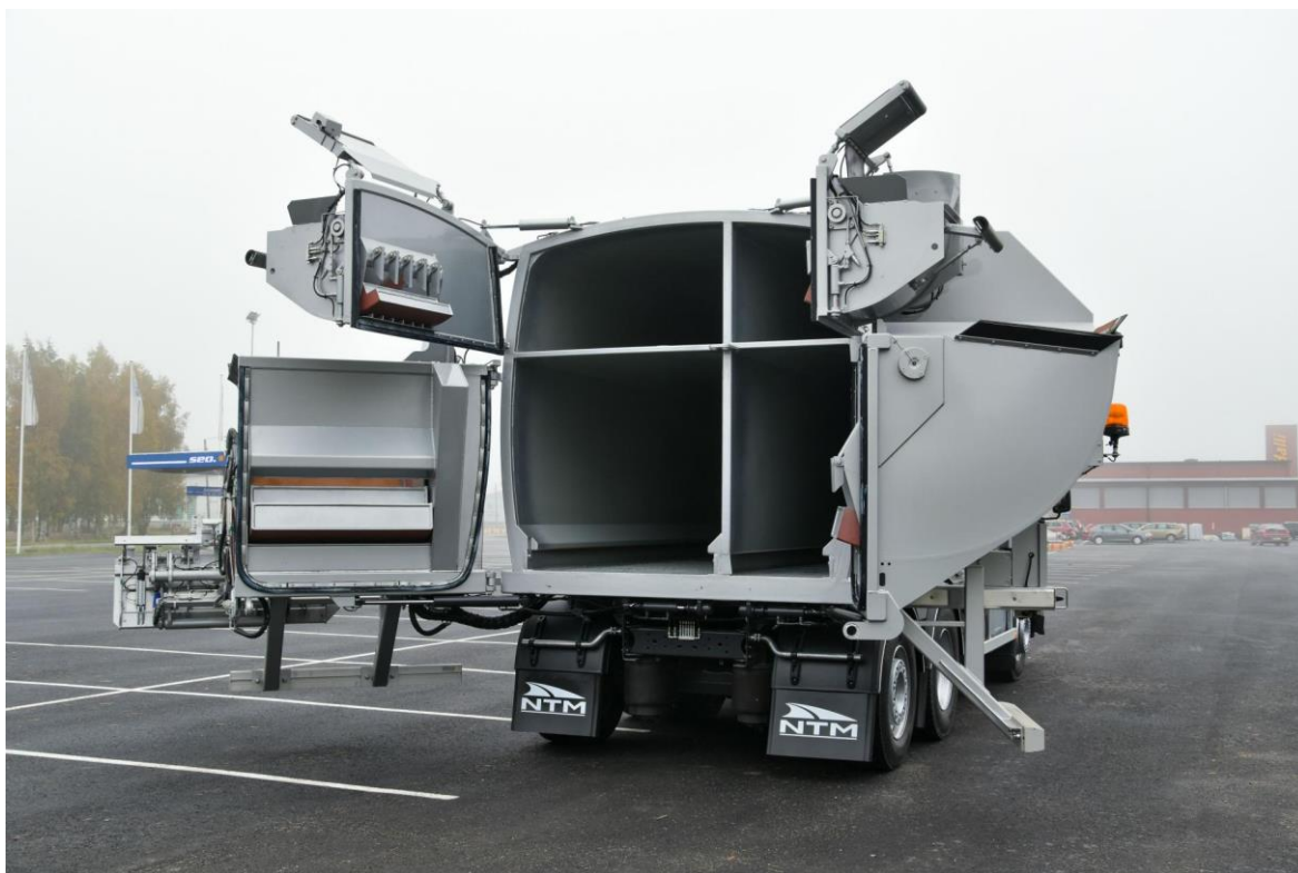
Bild 1. Renhållningsfordonet Quatro, det lastas och töms bak på fordonet.
