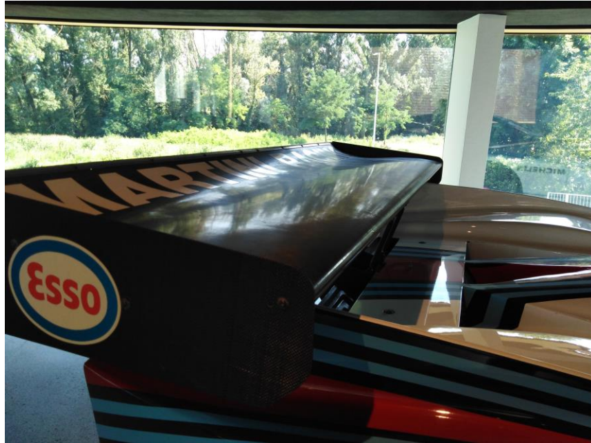
Kuva 6. Lancia LC2 C-ryhmän kilpa-auton takasiipi
