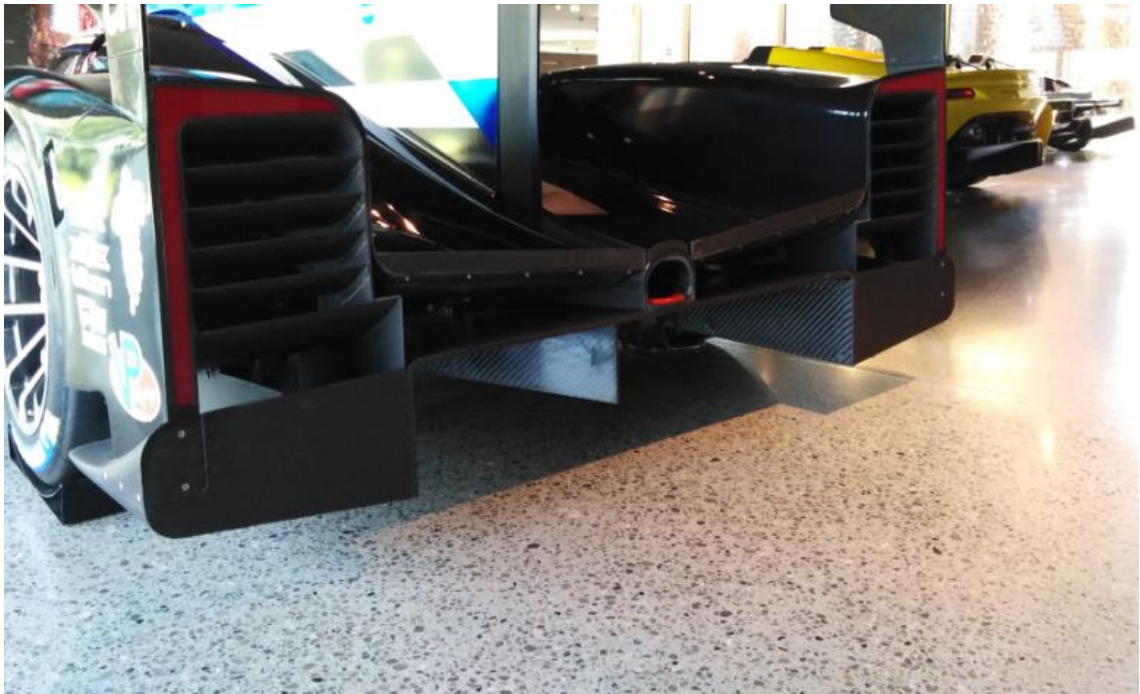
Kuva 10. Cadillac DPi V.R -kilpa-auton takadiffuusori
