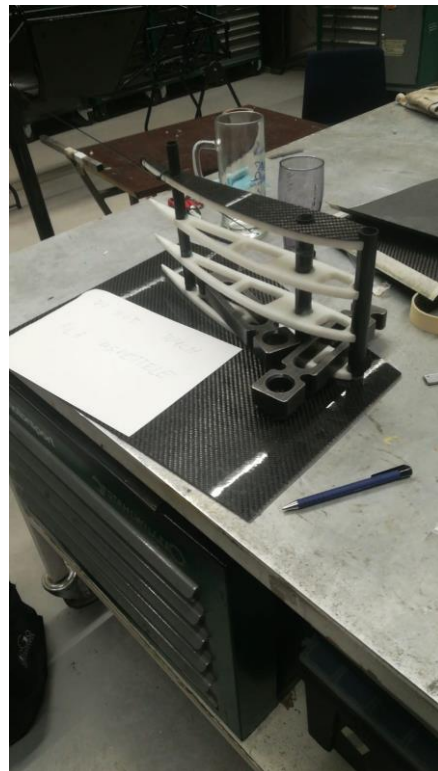
Kuva 48. Sivusiiven rakenteiden liimausta päätylevyyn
