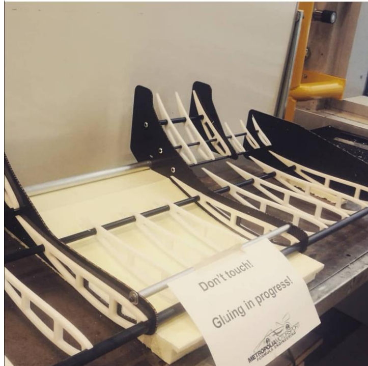
Kuva 47. Etusiiven rakenteiden liimausta
