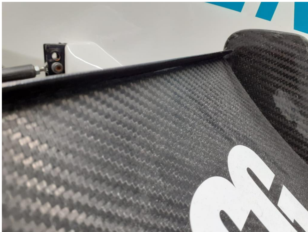
Kuva 12. Gurneyn flap HPF019-auton etusiivessä
