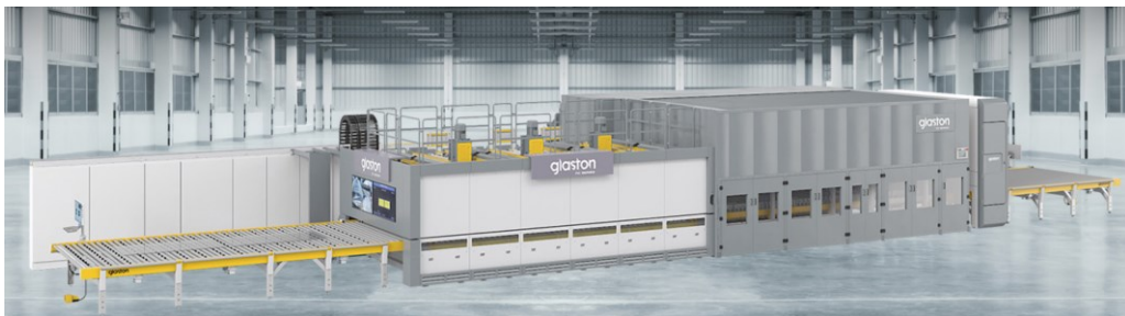
KUVA 1. FC-sarjan tasolasinkarkaisulinja (glaston.net 2019)
