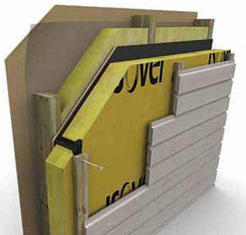
KUVIO 5. Ulkopuolinen lisälämmöneristys, esimerkki rakenne (Rakentaja.fi 2013)
