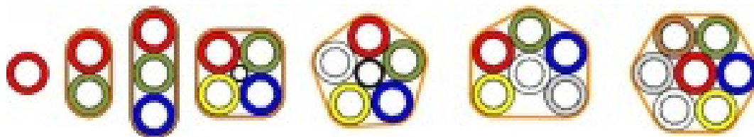
KUVA 8. Esimerkkejä mikroputkista ja niiden värityksestä. ( https://www.emtelle.com/microducts-the-myth-and-mystery-explained/ )
