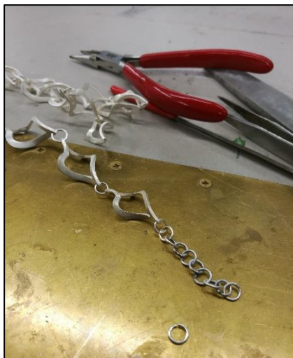
Kuva 38. Lenkkien lisäämistä korun taakse
