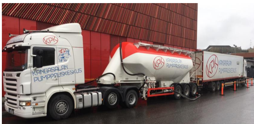
KUVA 1. Pumpputasoiteauto (Kangasalan Pumppauskeskus n.d)
