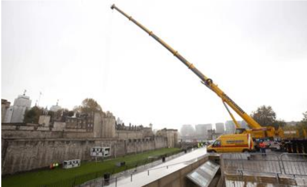
Kuva 1. Nykypäivän mobiilnostureilla ei ole ongelmia yltää yli 60 metriin. Kuvassa Liebherr LTM 1250-1, jonka puomin pituus on 72 metriä. 8
