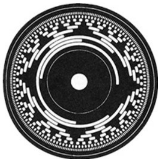
KUVA 4. Absoluuttianturin kiekko (Linear Motion Tips 2015)
