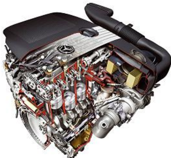
Kuva 7. 2-vaiheahdettu ajoneuvomoottori Mercedes-Benz OM 651. Molemmat ahtimet on sijoitettu moottorin oikealle puolelle. /8/
