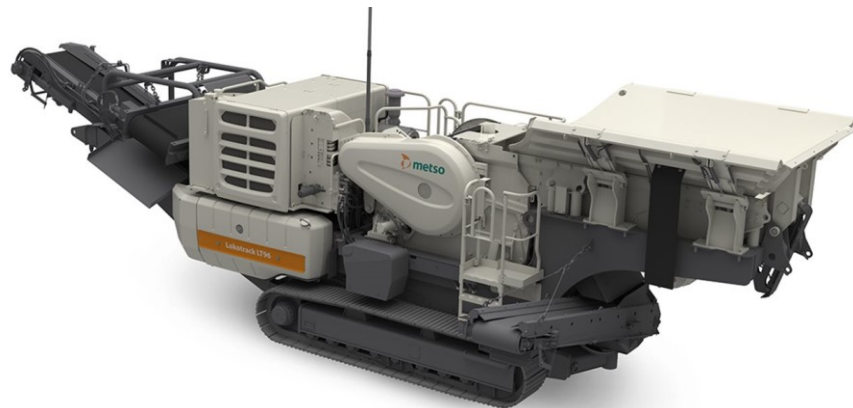
KUVA 1. Lokotack LT 96 -mobiilileukamurskauslaitos (Metso 2020)
