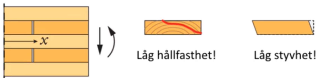
Figur 31. Tvärsnitt som är utsatt för tvärkraft belastning och skjuvspänning. (Svenskt Trä, 2017)
