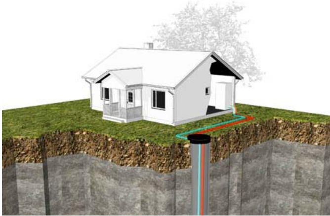
Kuva 16. Kallioon asennetut keruuputket (Geoenergia.fi 2010)
