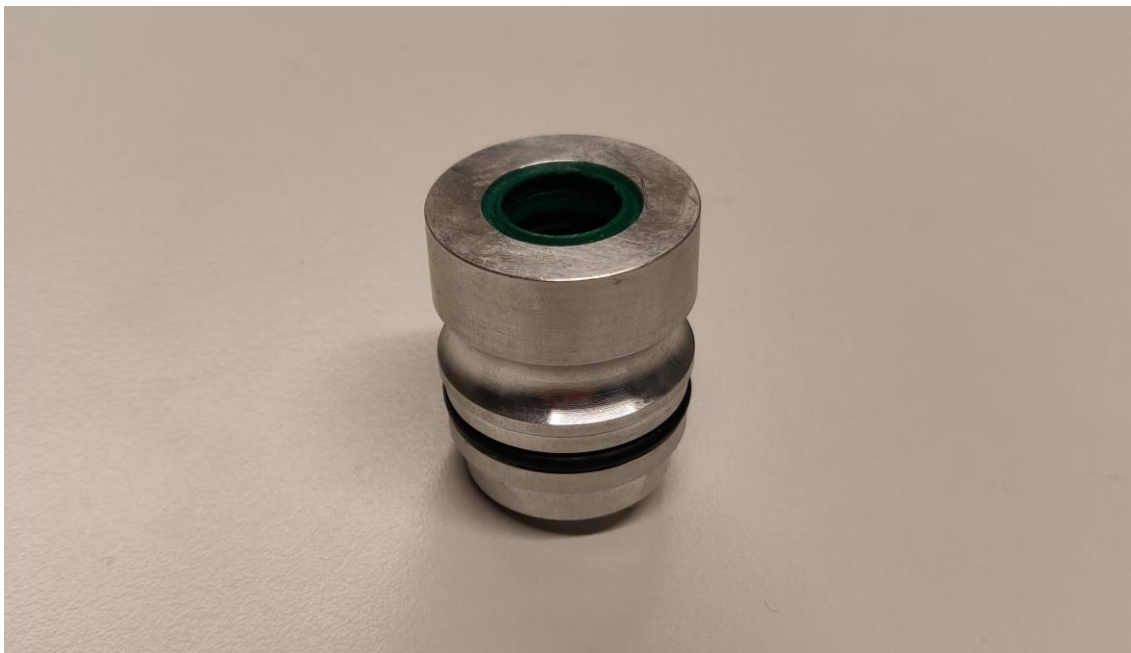
Kuva 14. Festo Oy:llä käytössä oleva liukulaakeri.
