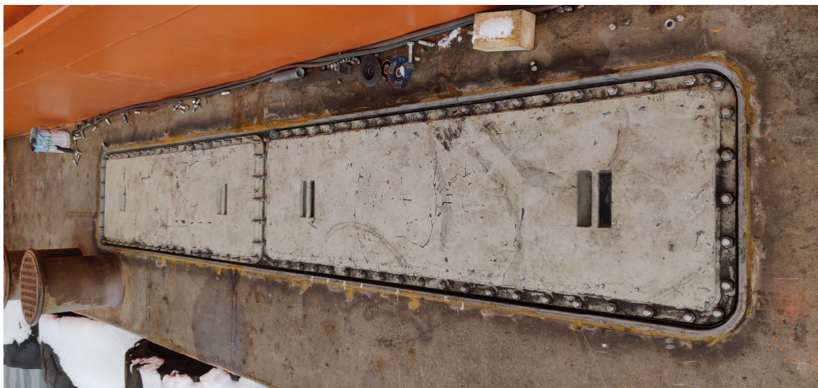
Figur 19 – Manluckorna på plats var man fäller ner kylarna till sjökistan. (Figur 20)
