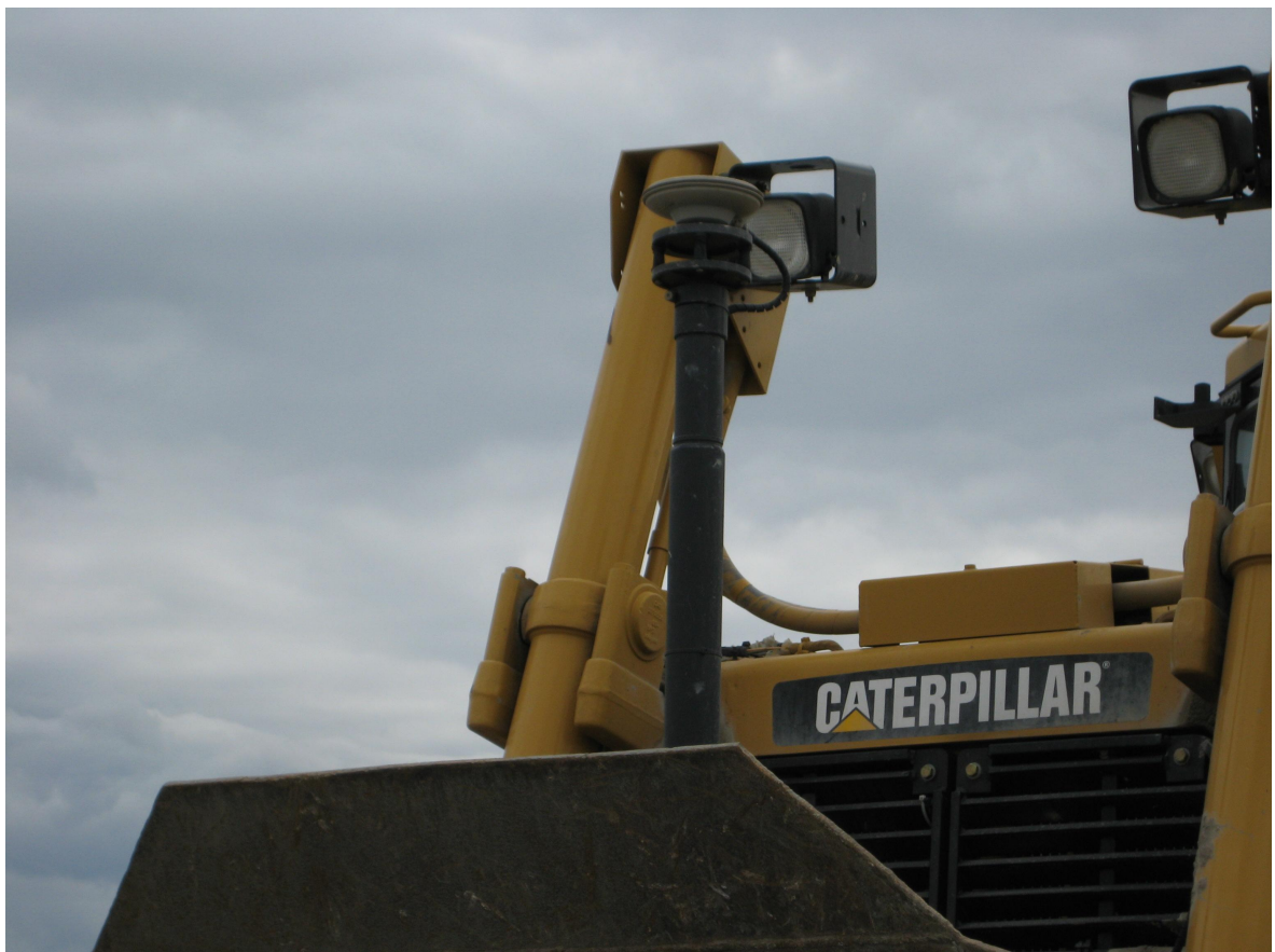
Kuva 6. Puskukoneen gps-antennin varren on oltava kestävä.
