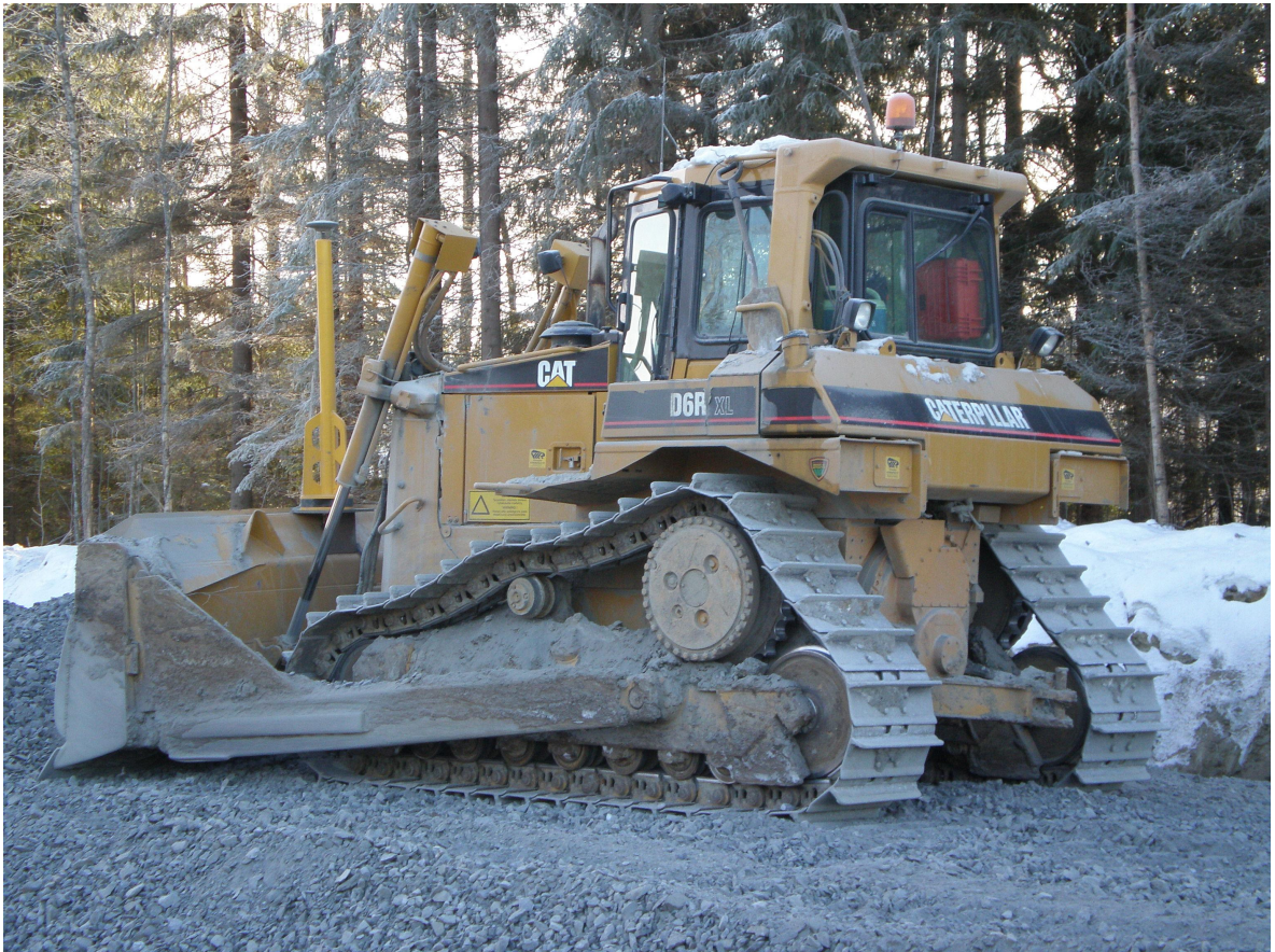
Kuva 4. Puskukone varustettuna GPS-antennilla
