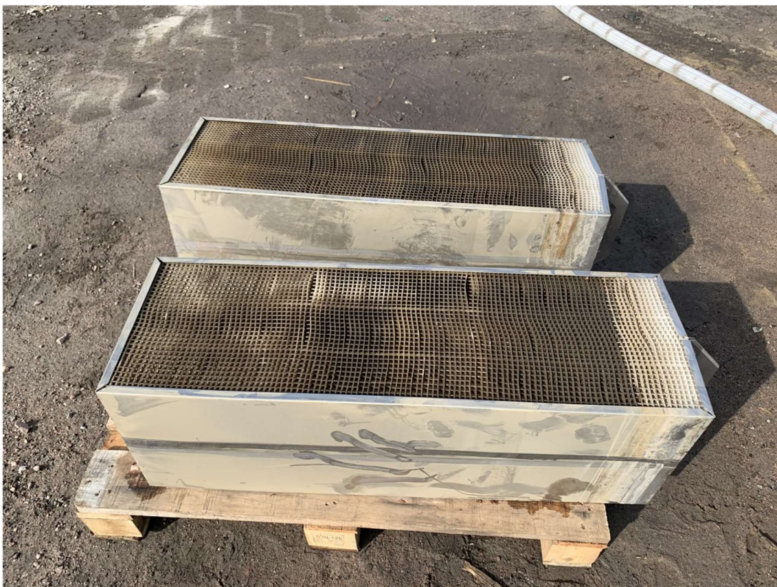
Kuva 7. Koalisaattorit puhdistettiin noin kahden kuukauden välein.
