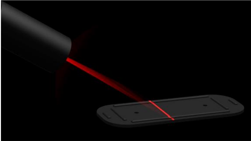
Kuvio 15. Laserviivalla toteutettu rakenteellinen valaisu (Leino ym. 2014b, 30).
