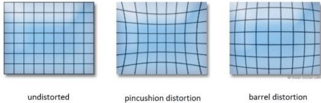
Kuvio 4. Neulatyyny- (keskellä) ja tynnyrivääristymä (oikealla) (Vision Doctor 2020b).
