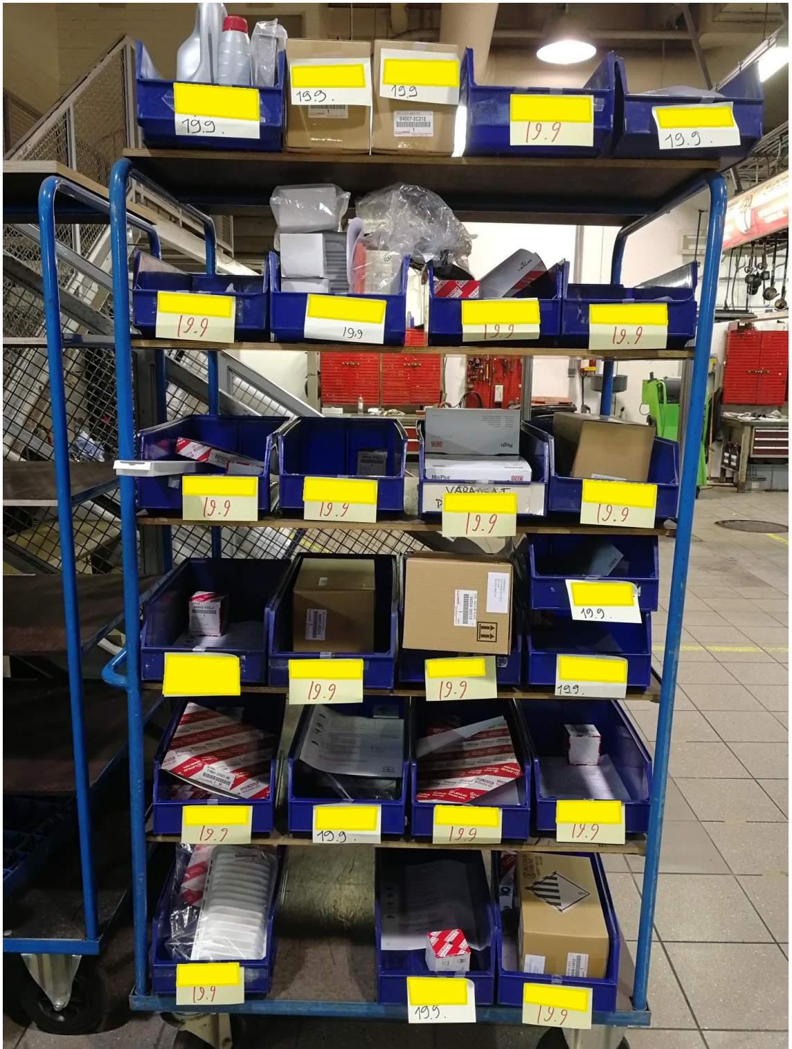
Kuva 22. Ennakkokärry, jossa on kerättyä kyseiselle päivälle varattujen töiden varaosat.
