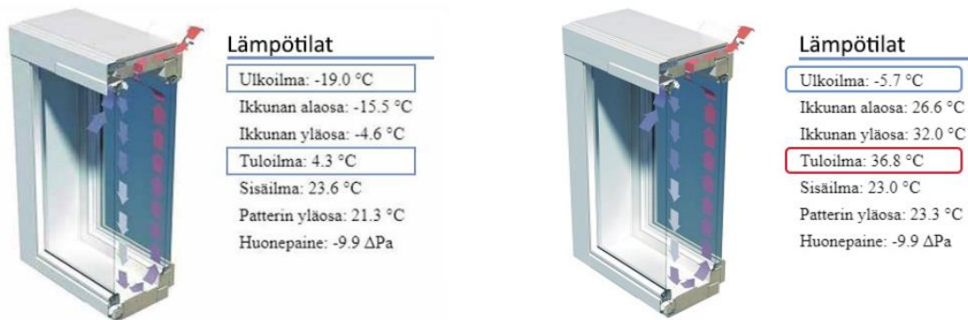
KUVA 9. Air-Termico PRV 800 -venttiilin tuloilman esilämmitys
