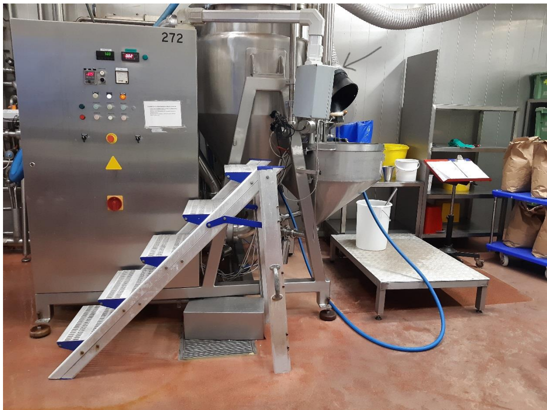
Kuva 5 Koneen 272 tikkaat sekä koneen säätönapulat.
