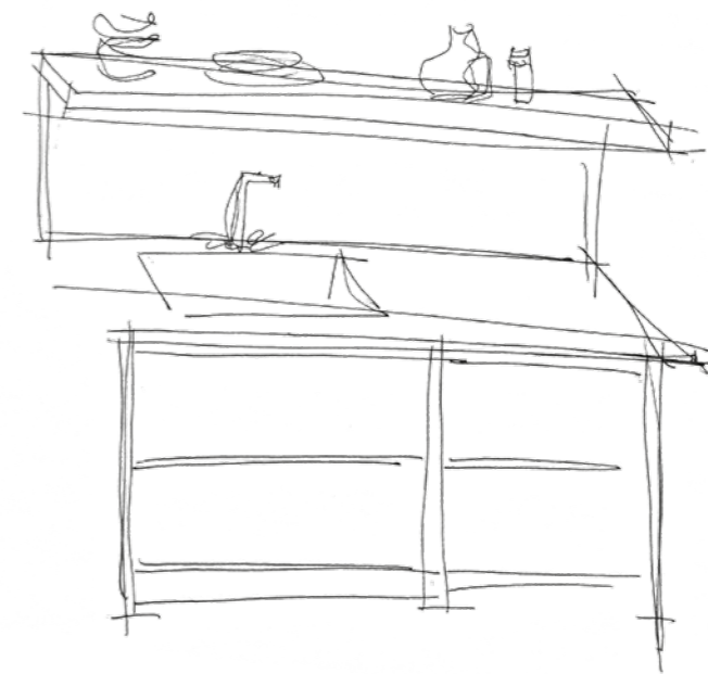
Keittiössä työtason päällä hylly jobon upotetaan työvalo
